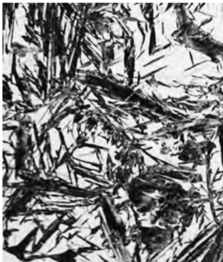
Figura 2.6 – Micrografia obtida por microscopia ótica apresentando uma estrutura martensítica [8]
