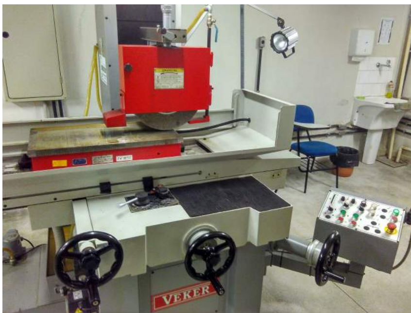
Figura 3.6 – Retificadora plana tangencial Veker RVK-6030
