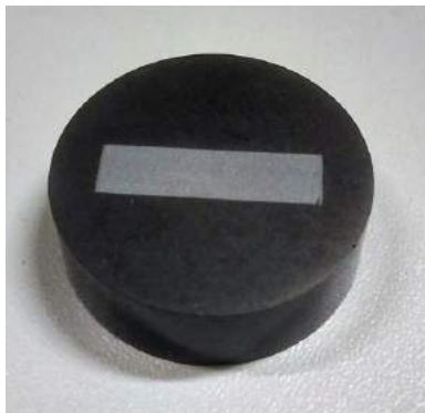
Figura 3.8 – Amostra embutida, polida e atacada quimicamente
